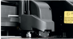
Abb. 4.11-4: Schneidekopf mit Sensor und Tangentialmesser
