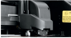
Abb. 5.7-16: Schneidekopf mit Sensor und Tangentialmesser
