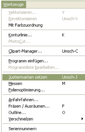
Abb. 4.7-15: Werkzeug-Menü zum Setzen der Justiermarken
