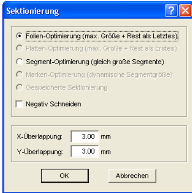
Abb. 4.7-41: Sektionierungs-Dialog mit Überlappungswert von 3 mm
