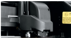
Abb. 4.7-16: Schneidekopf mit Sensor und Tangentialmesser
